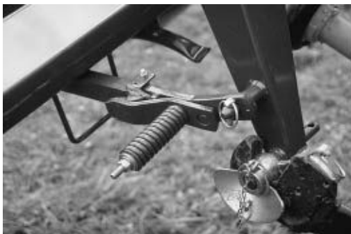
Figuur 1-17: Een obstakelbeveiliging zorgt ervoor dat de maaier ongeveer 1 meter naar achteren zwenkt.
