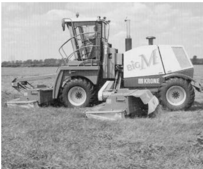
Figuur 1-10: Een zelfrijdende maaier die speciaal bedoeld is om gras te maaien.
